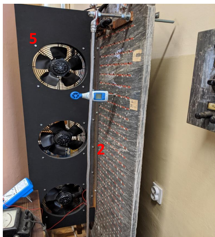
Сл. 6. Вентилатори којима се проводник форсирано хлади
