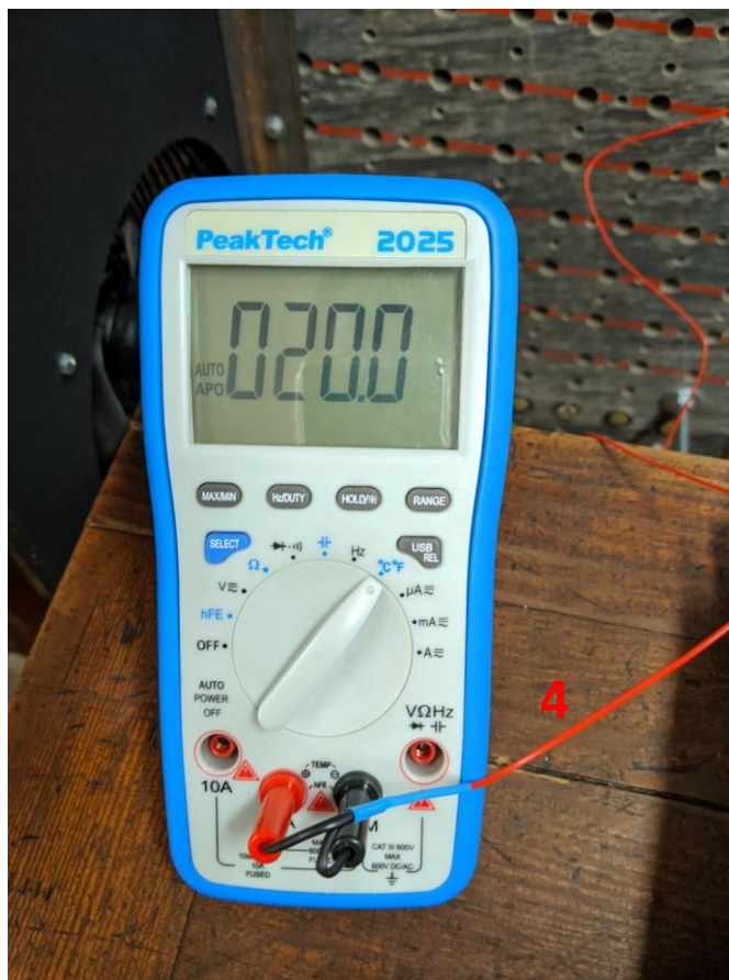
Сл. 7. Мултиметар којим се мери температура проводника
